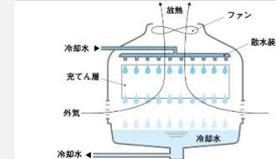
クーリングタワーは、水が蒸発する際に熱を奪う気化熱の原理を利用した冷却装置です。この原理を使って冷やした冷却水を円滑に循環させる必要があります。そのために補給すべき水量を把握し、運用できるよう取り組んでいます。
